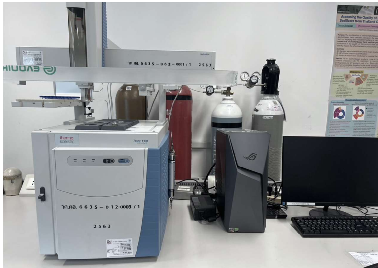
เครื่อง GC-FID รุ่น TRACE 1300 GC equipped with a TriPlus RSH autosampler and a flame ionization detector (FID). Chromeleon software version 7.2.10 ยี่ห้อ ThermoScientific
